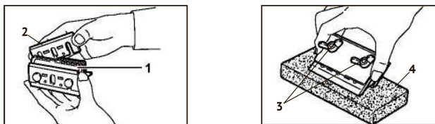
1 - держатель ножа; 2 - нож; 3 - гайки крепления; 4 - брусок
